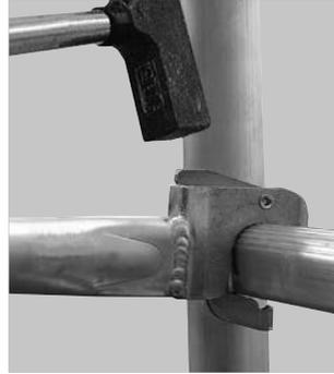
Alle Geländer- und Diagonalstreben müssen unmittelbar nach dem Zusammenstecken verriegelt werden.
