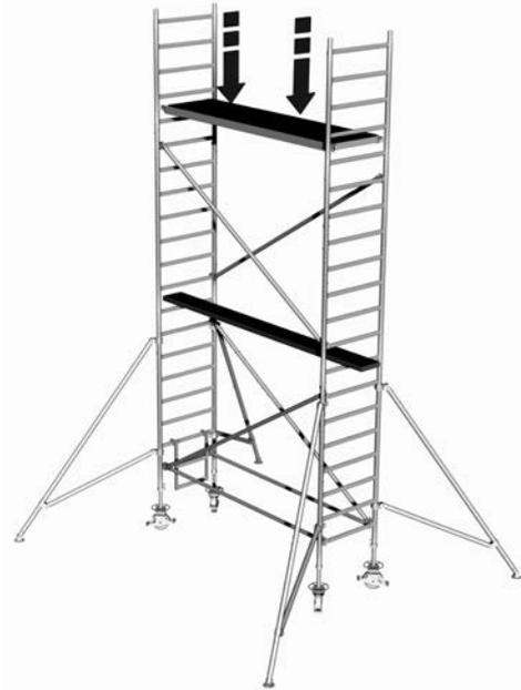
Setzen Sie die Belagbühne wie gezeigt mit den Haken auf die 5. Sprosse von oben der Vertikalrahmen ein.
