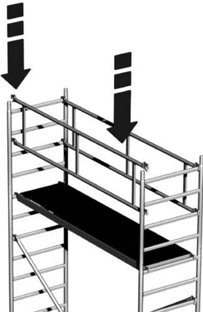
Montieren Sie nun die Geländerrahmen wie gezeigt. Verriegeln Sie die Verbindungen.
