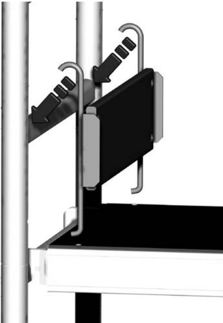
Setzen sie die Querboards, wie im nebenstehenden Bild gezeigt, mit den Haken auf die erste Sprosse über der Belagbühne ein.
