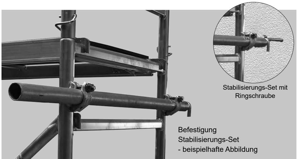
Bei der Verwendung der Stabilisierungs-Sets ist darauf zu achten, dass diese immer unterhalb der obersten Belagbühne angebracht werden.
