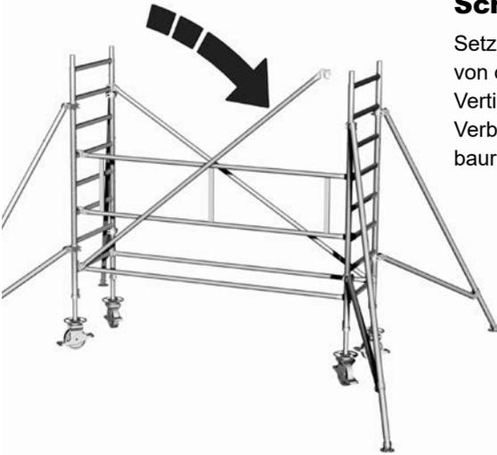
Entfernen Sie den hilfsweise eingebauten Geländerrahmen. Die Gerüstbasis ist nun stabilisiert.
