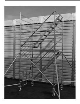
Bauen sie auf beiden Seiten der Vertikalrahmen je 2 Geländerstreben in die zweite und vierte Sprosse ein. Hängen Sie die Diagonale, wie im Bild gezeigt, oberhalb der Belagbühne ein.
